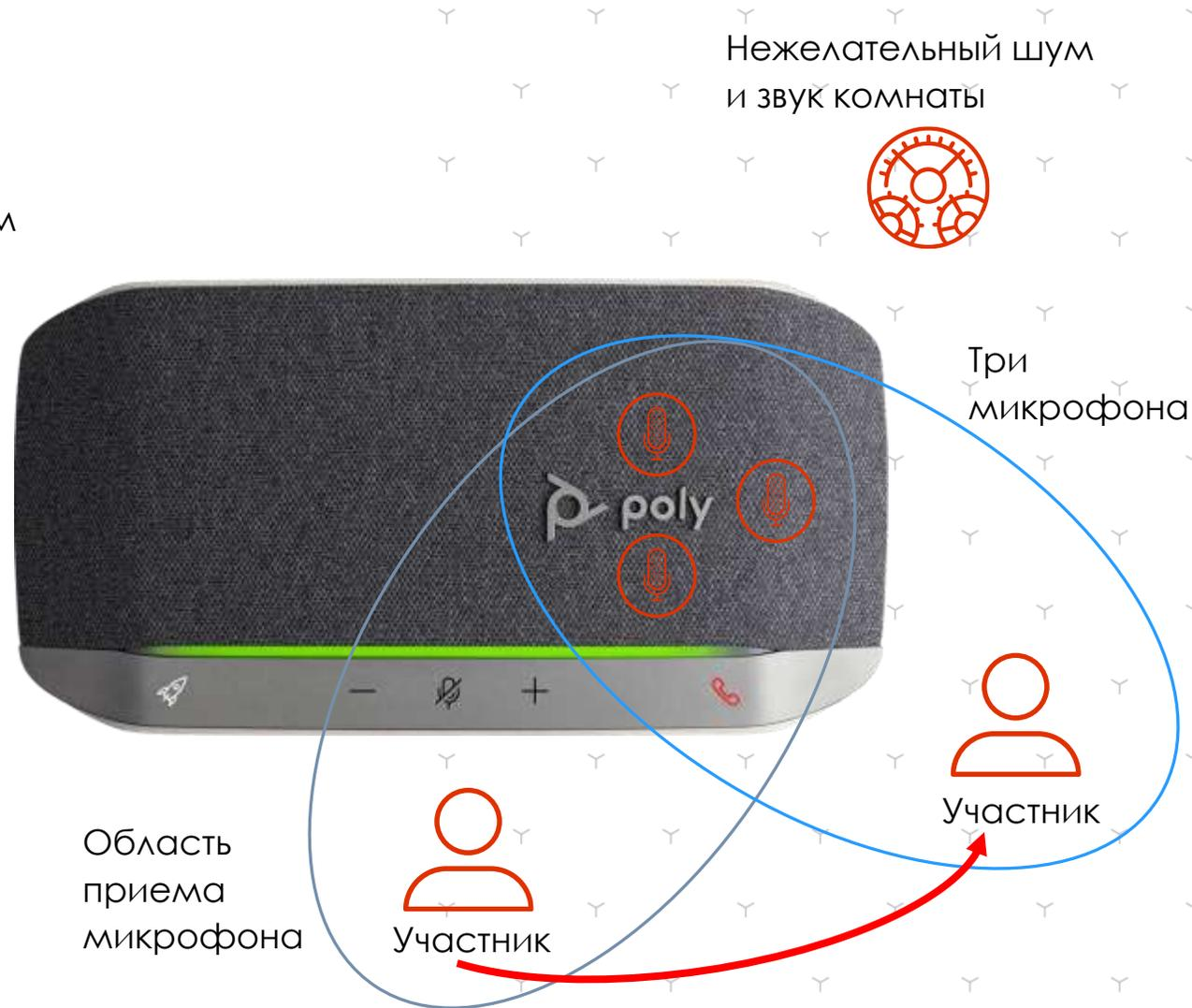
Управляемый массив из 3х микрофонов выбирает зону приема звука в зависимости от положения говорящего, отсекая все остальные звуки в помещении
